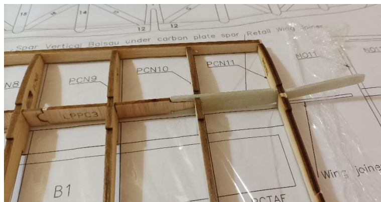
Clé d'aile en fibre de verre 2mm et nervure PCN11 positionné
