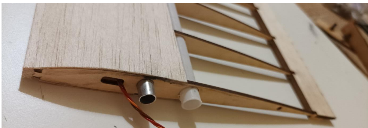
Emplanture prête à recevoir la nervure d'emplanture PCN1
