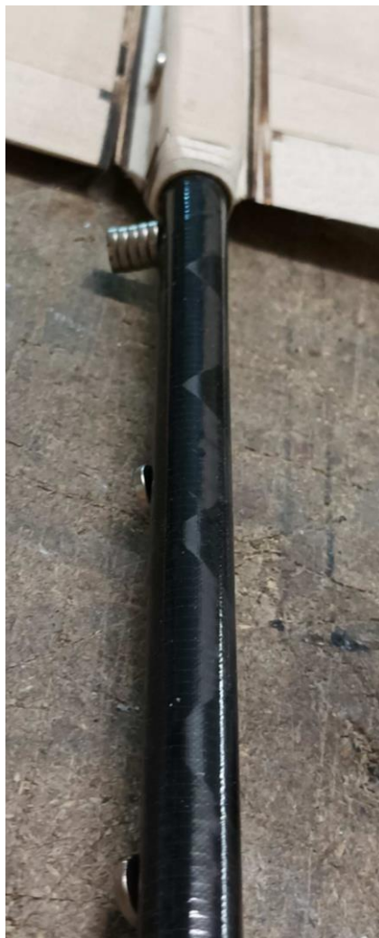
Collage de la gaine de commande avec les aimants
